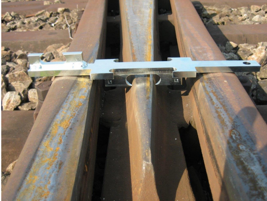
Sahada mastarın kanat rayları ve göbek ucu üzerinde konumlandırılması
